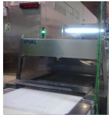
Balizas luminosas de marcha y paro en máquinas
